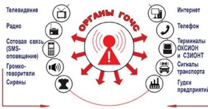
**СИСТЕМА ОПОВЕЩЕНИЯ ГРАЖДАНСКОЙ ОБОРОНЫ** — организационно-техническое объединение оперативно-дежурных служб, специальной аппаратуры управления и средств оповещения, обеспечивающих передачу сигналов гражданской обороны и речевой информации.
